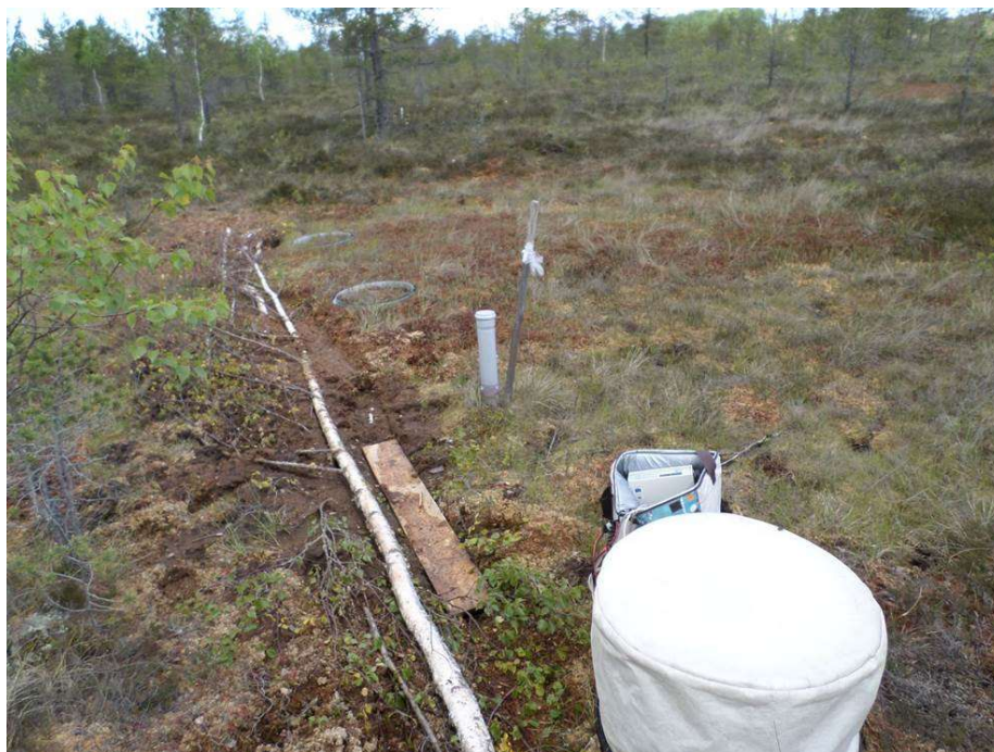
Joonis 1. Mõõtmisala. Pildil toimub ökosüsteemi hingamise mõõtmine kaetud kambriga ühel kambrirõngal. Pildil on taamal näha lisaks kaks kambrirõngast kordusmõõtmiste tegemiseks ja veevaatluskaev veetaseme mõõtmiseks.
