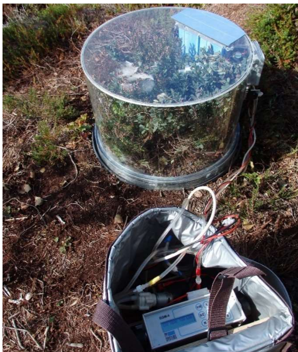
Joonis 3. Mõõtmisüsteem CO 2 voogude mõõtmiseks. Pildil on näha pleksiklaasist läbipaistev kamber lisadega ja infrapuna-gaasianalüsaator EGM-4.
