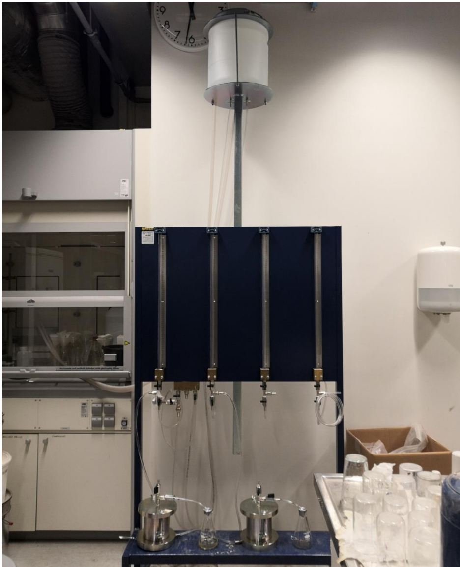
Joonis 5. Uurimistöös filtratsioonikonstandi mõõtmiseks kasutatud püsiva veetasemega permeameeter.
