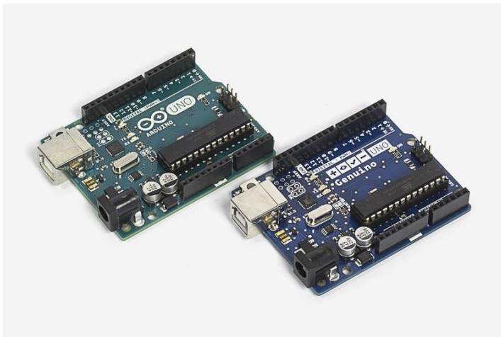
Joonis 2. Arduino UNO ja Genuino UNO arendusplaadid [11]
