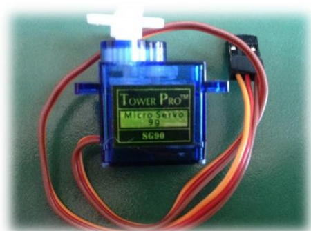
Joonis 28. 180-kraadine ehk poolpöörde seromootor
