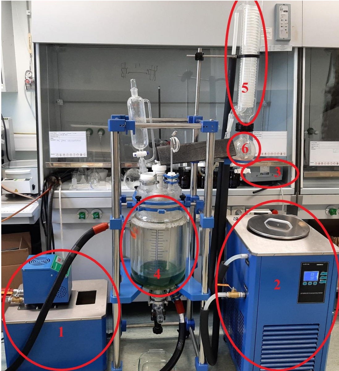
Joonis 2. Töös kasutatud destillatsiooniseade
