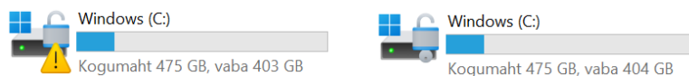
Pilt 1. Vasakul Bitlockeri poolt dekrüpteerimata ketas hoiatusikooniga ja paremal Bitlocker poolt krüpteeritud ketas ilma hoiatusikoonita
