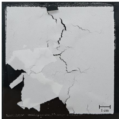
Joonis 12. Siiditrükiga valmistatud TLC plaat tselluloosi osakeste sisaldusega 300 \text{ mg ml}^{-1}
