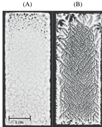
Joonis 9. Madala viskoossusega trükipastast kiip (A), tselluloosi osakeste kontsentratsioon 200 \text{ mg ml}^{-1} . Kõrge viskoossusega trükipasta kiip (B), tselluloosi osakeste kontsentratsioon 325 \text{ mg ml}^{-1}
